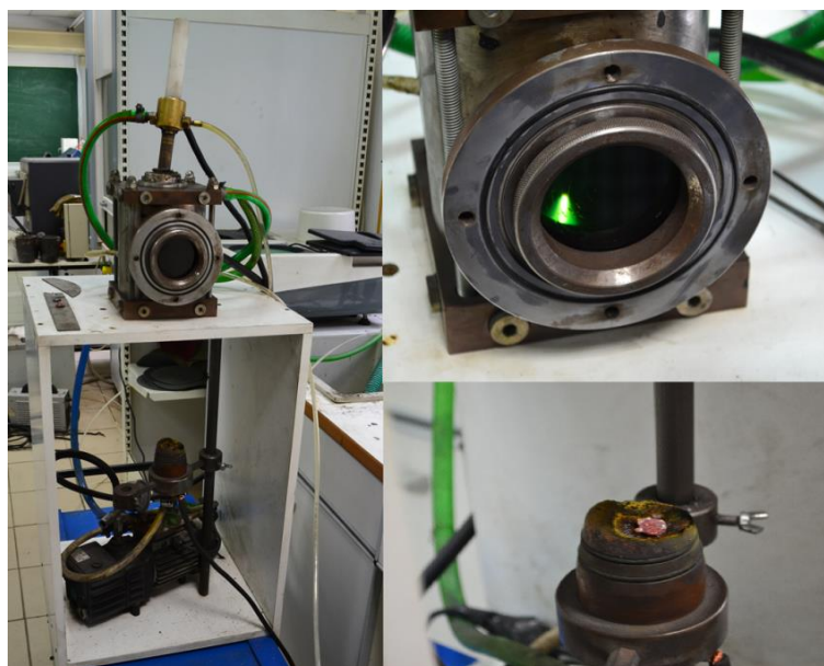
Obr. 4: Vakuová oblouková tavicí pec
