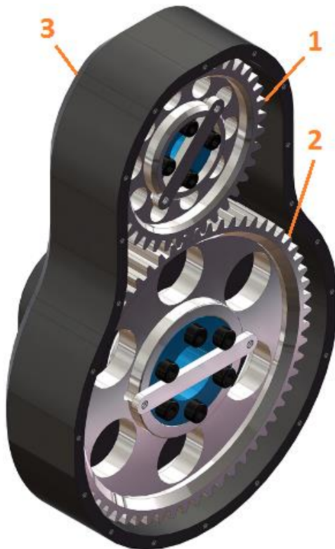
Obrázek 17 – Ozubené soukolí; 1 – pastorek, 2 – hnané kolo, 3 – skříň
