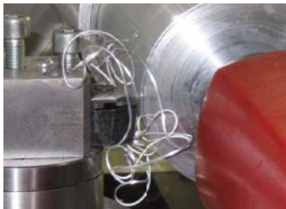
Obr. 3.2 Tvorba plynulé dlouhé třísky (9)
