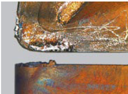
Obr. 2.2 Nárůstek na nástroji (6)
