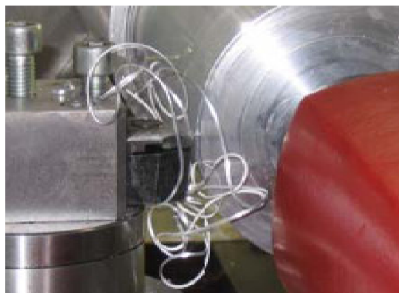
Obr. 3.2 Tvorba plynulé dlouhé třísky (9)
