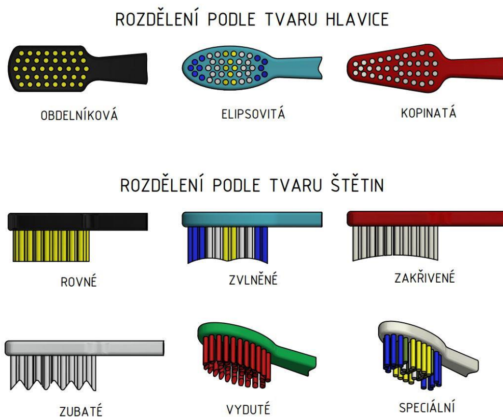
Obr. 2-2 Rozdělení kartáčků podle tvaru hlavičky a tvaru štětín
