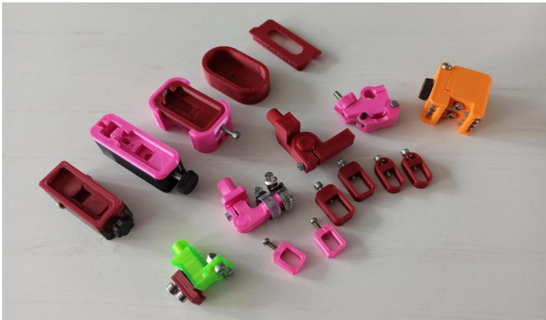
Obr. 5-12 Prototypy upínačů zubních kartáčků a van, vyrobené pomocí metody 3D tisk.
