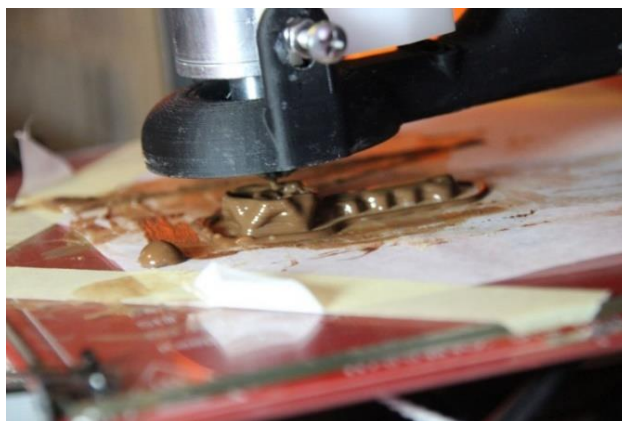
Obrázek 21: Ukázka upravené trysky tiskárny Prusa i3 plus
