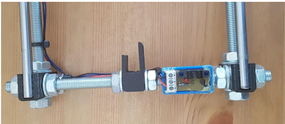
Obrázek 22: Poškozený držák kladky na ose Y
