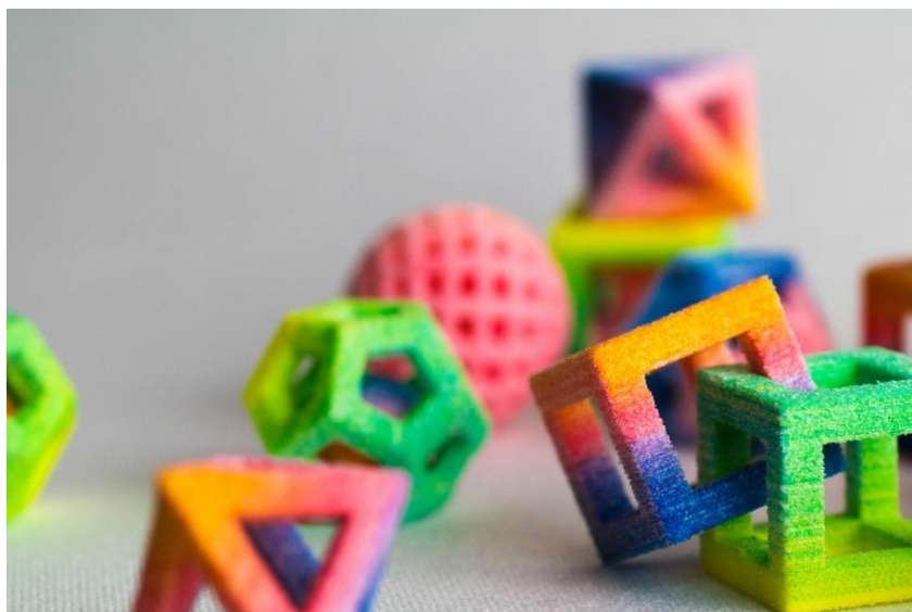
Obrázek 19: Ukázka výtisku z tiskárny ChefJet Pro za použití různě obarveného cukru [23]
