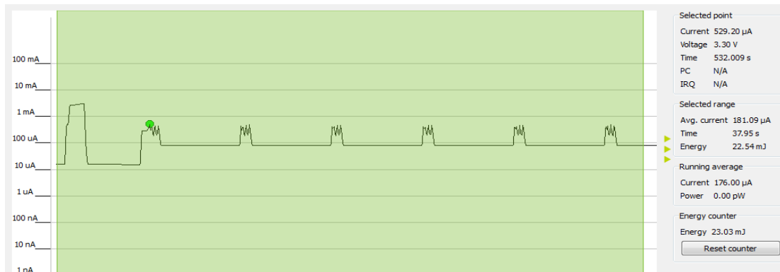
Obr. 4-21 Meranie spotreby - senzory sú napájané z VMCU
