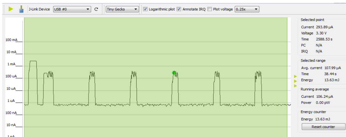
Obr. 4-22 Meranie spotreby - senzory sú napájané z GPIO
