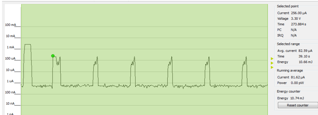
Obr. 4-20 Meranie spotreby - senzory sú napájané zvlášť
