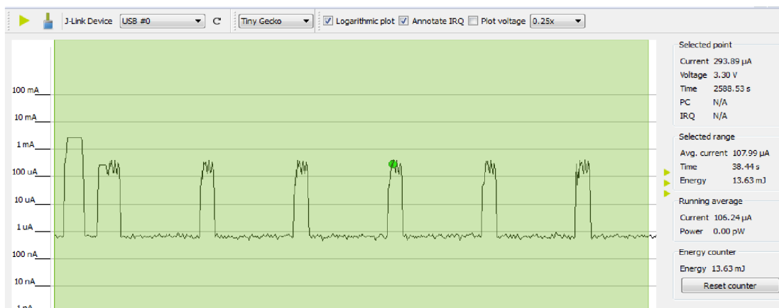
Obr. 4-22 Meranie spotreby - senzory sú napájané z GPIO
