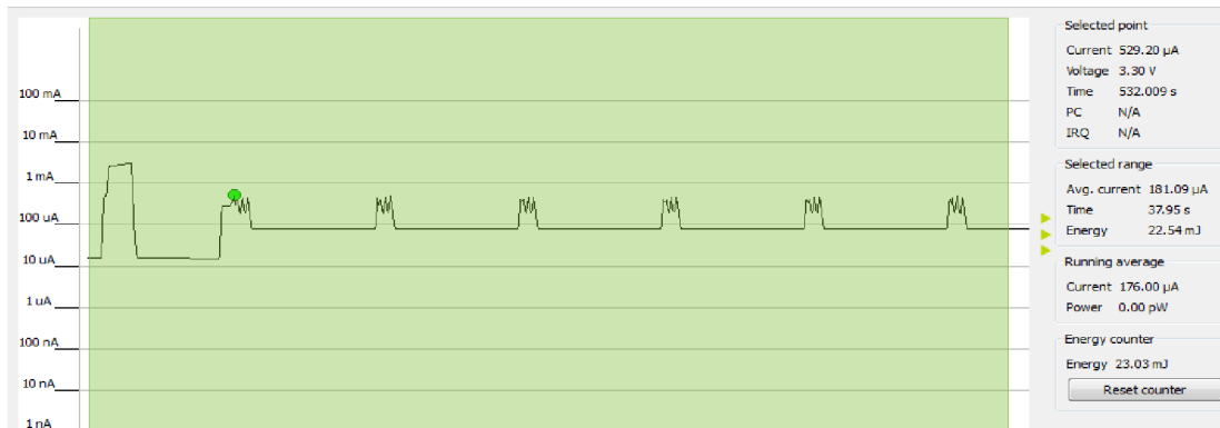
Obr. 4-21 Meranie spotreby - senzory sú napájané z VMCU
