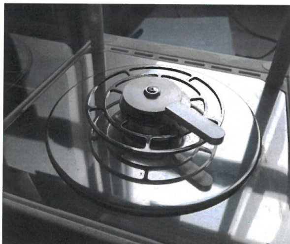
Obrázek 15 Pánvička se vzorkem připravená k termické analýze
