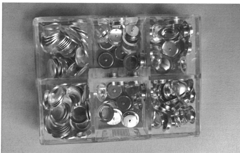
Obrázek 9 Hermetické hliníkové pánvičky a víčka v zásobníku
