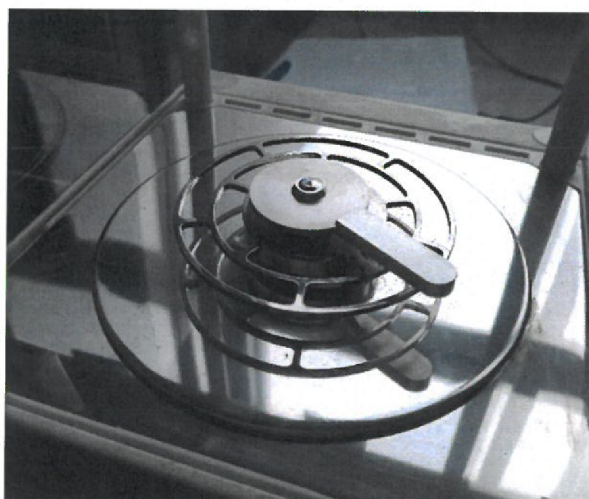
Obrázek 15 Pánvička se vzorkem připravená k termické analýze
