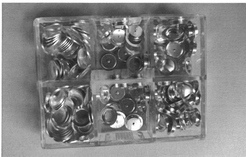
Obrázek 9 Hermetické hliníkové pánvičky a víčka v zásobníku
