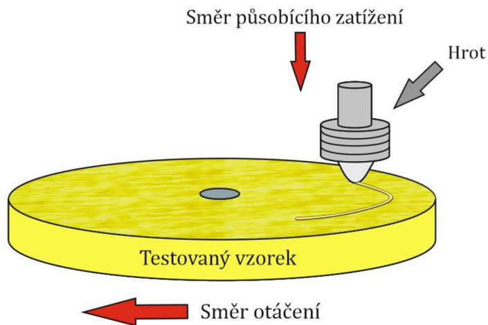
Obr. 3: Schéma metody pin-on-disk
