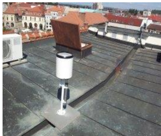
Obrázek 3 Srážkoměr – střecha městského úřadu v Uherském Hradišti
