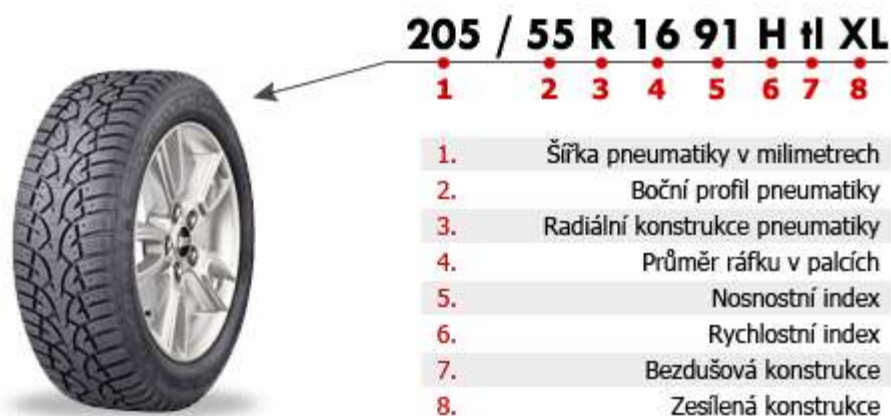
Obrázek 2 Značení pneumatiky
