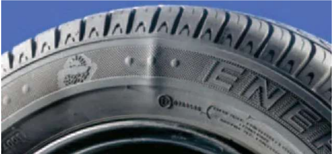
Obrázek 8 Vada pneumatiky - vyboulení
