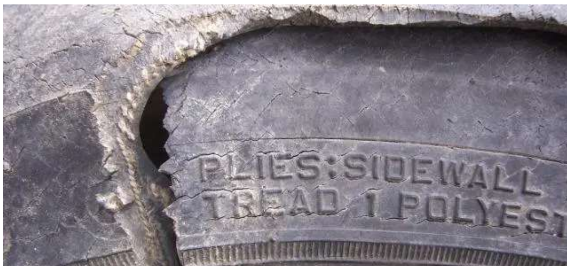
Obrázek 6 Poškození podhuštěné pneu
