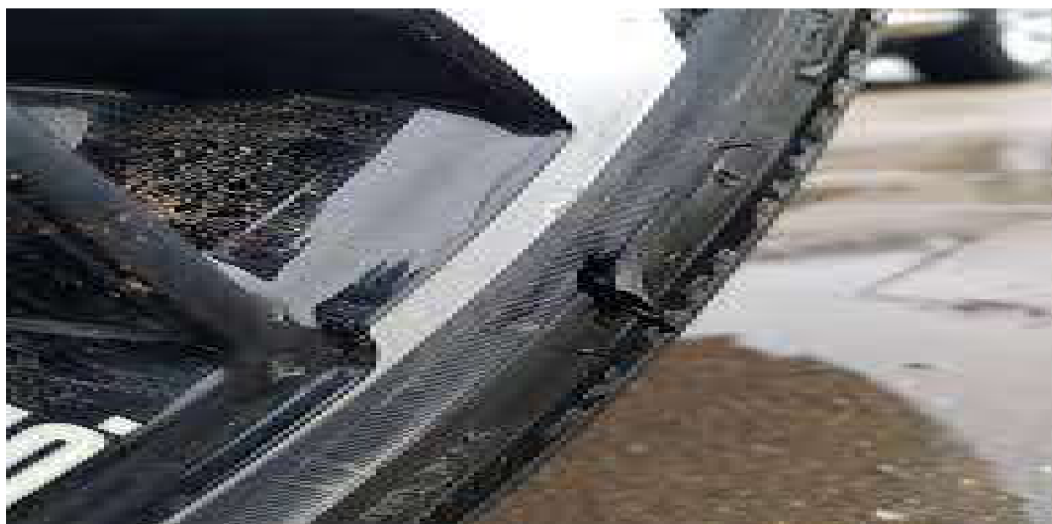
Obrázek 7 Boční poškození pneumatiky
