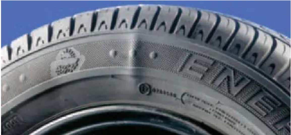
Obrázek 8 Vada pneumatiky - vyboulení
