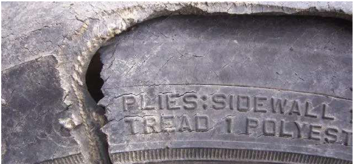
Obrázek 6 Poškození podhuštěné pneu
