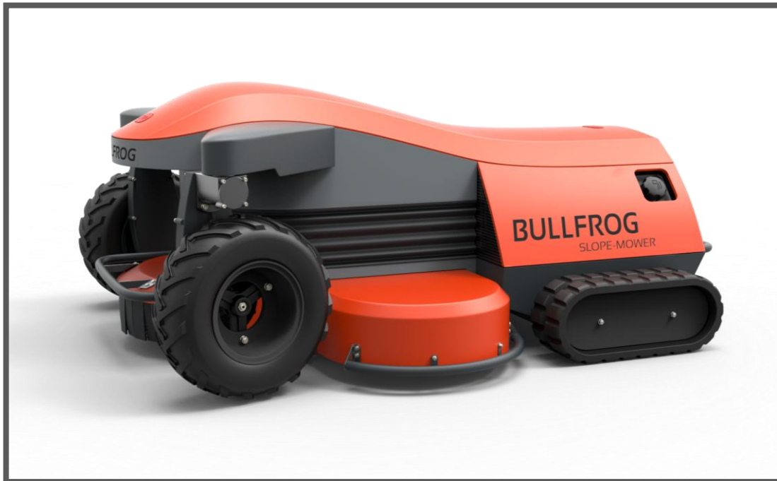
Obr. 4-3 Boční perspektivní pohled na tvarování vrchního dílu kapotáže a jeho návaznost vzhledem k charakteru obou podvozkových částí.
