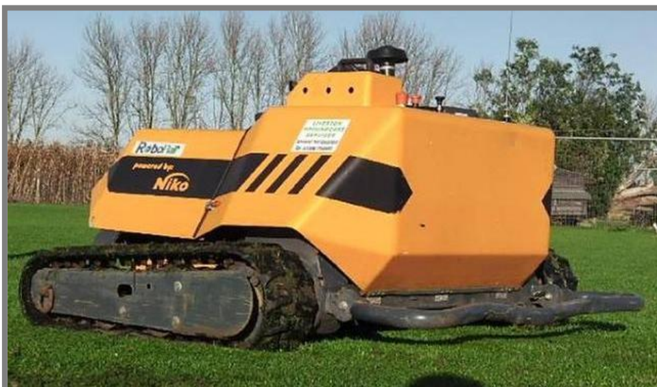
Obr. 1-31 Nepodařené tvarování zadní plochy RoboFlail one [64]
