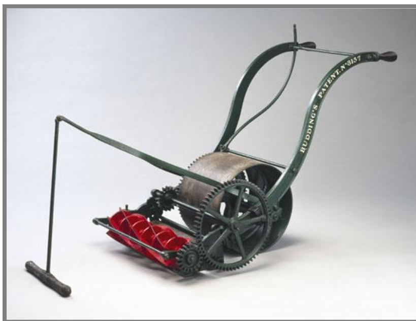
Obr. 1-1 Jeden z prvních žacích strojů, postavený firmou Ransomes, dle patentu Edwina B. Buddinga v roce 1832 [21]
