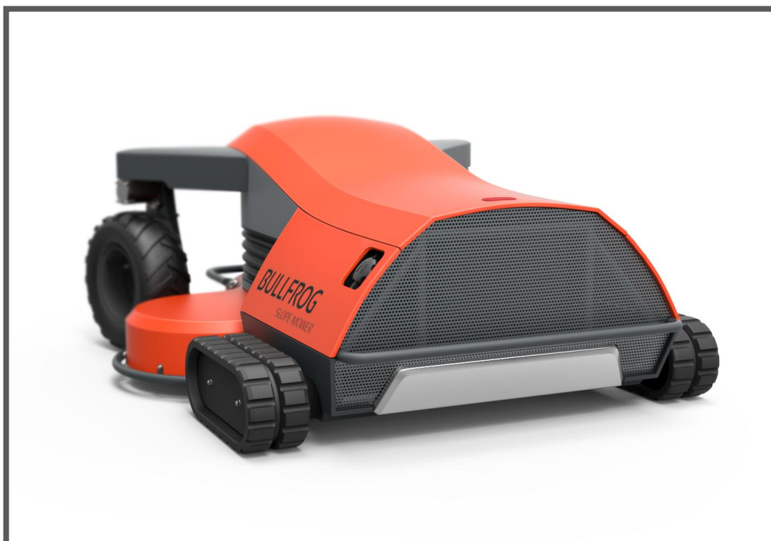
Obr. 4-7 Tvarování zadní části sekačky
