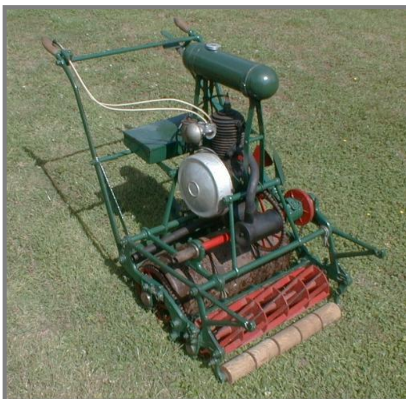
Obr. 1-4 Atco Standard, první motorová sekačka dostupná v několika velikostech, vyráběná ve velkých sériích [4]
