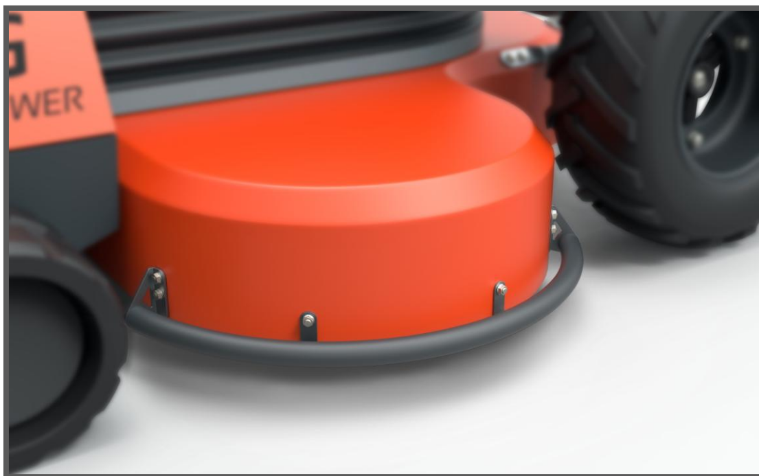
Obr. 4-8 Detail bočního ochranného rámu
