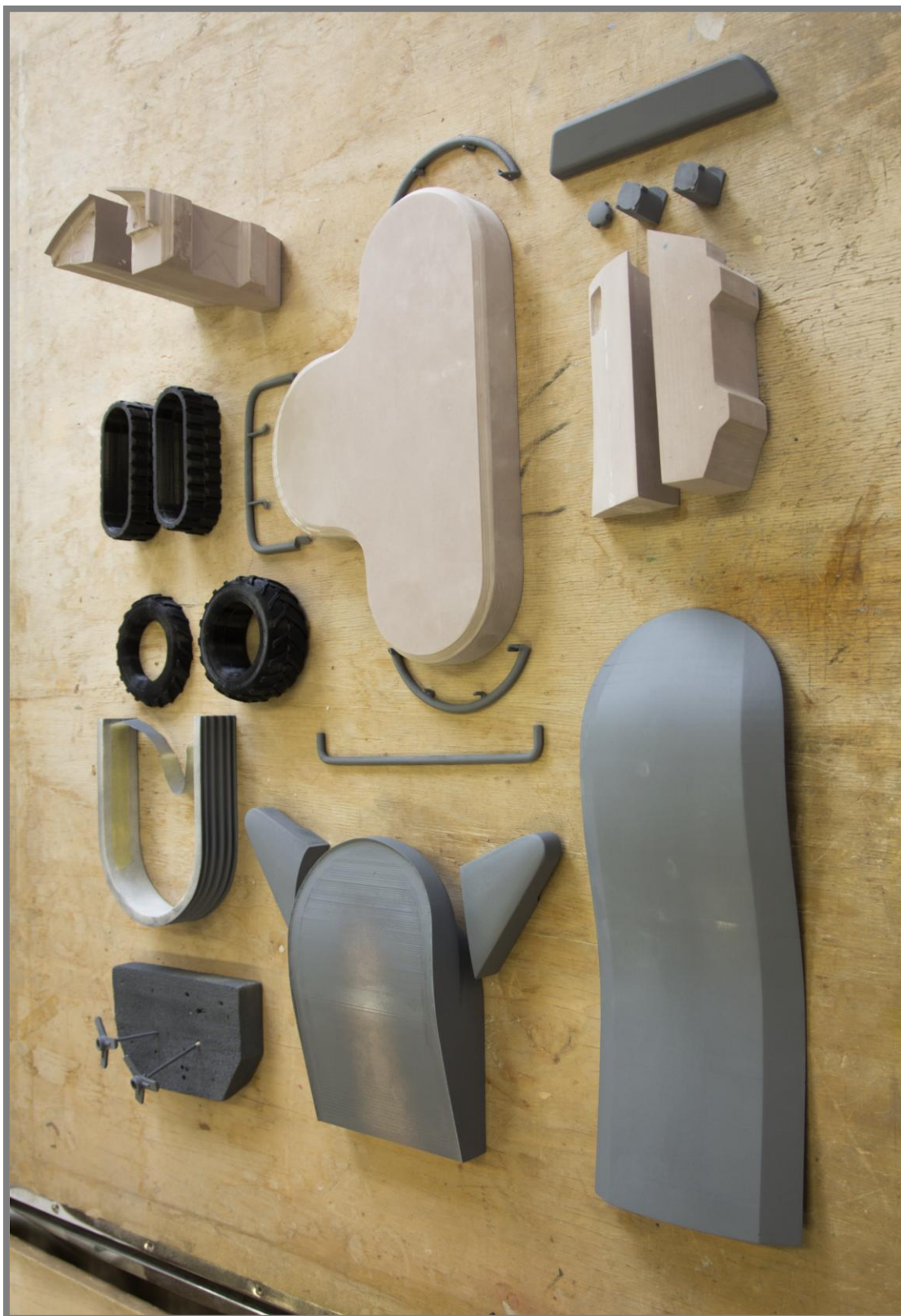
Fotografie rozložených částí modelu, vyrobených obráběním frézou a 3D tiskem.
