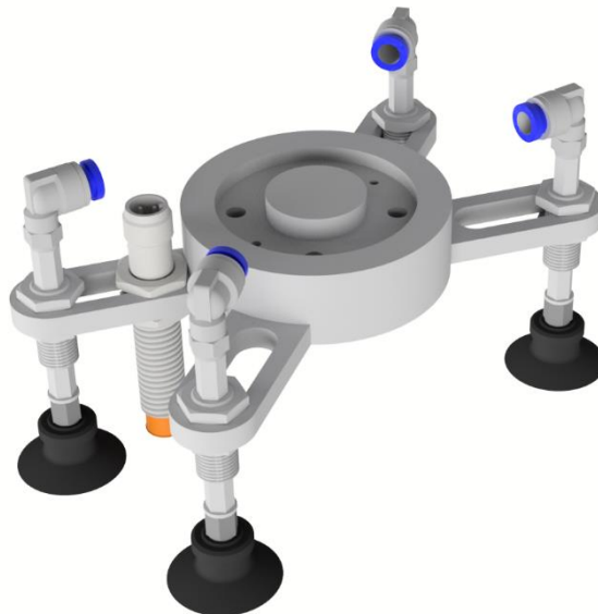
Obr. 17) 3D model použitého gripperu s přísavkami firmy SMC
