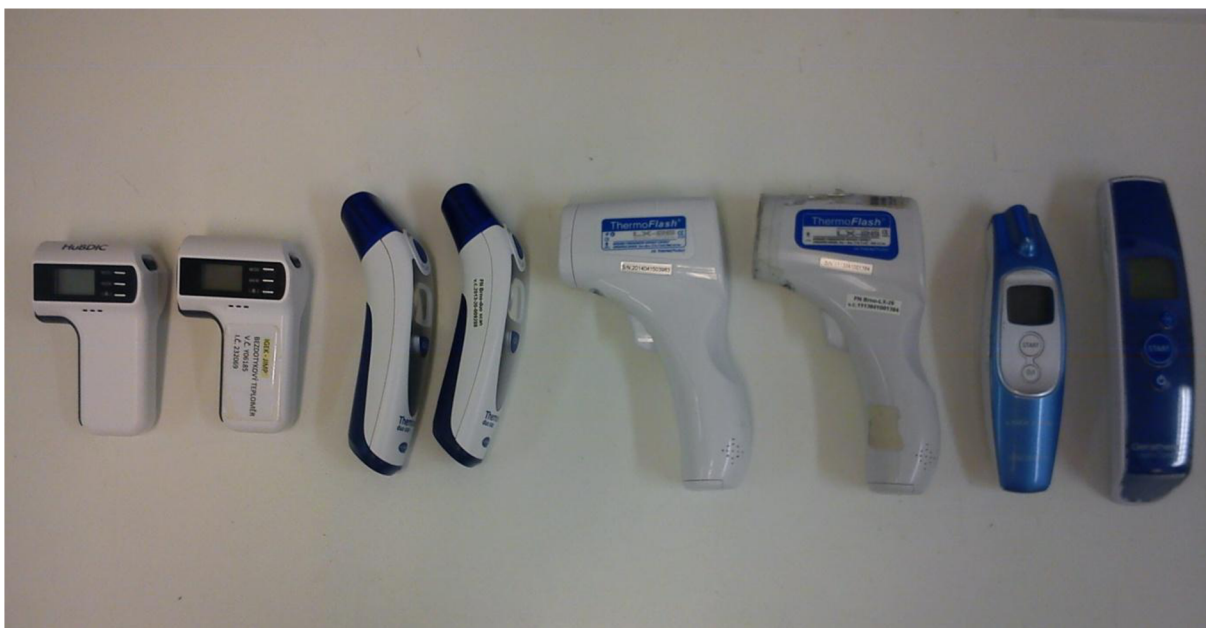
Obrázek 5.1 – Použité teploměry k měření. Zleva 2x teploměr Thermofinder FS-300, 2x teploměr ThermoFlash LX-26, teploměr MicroLife NC 100, teploměr Geratherm GT-101.
