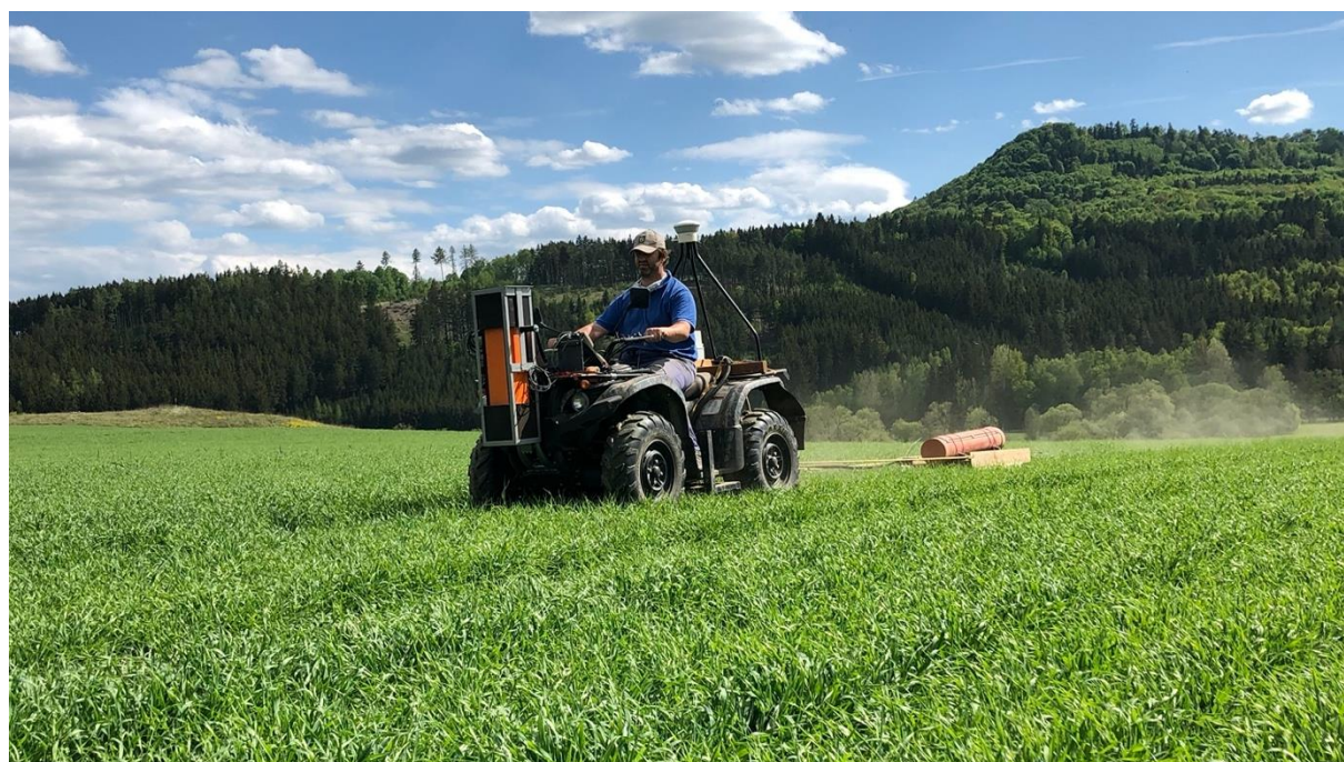
Obr. 4: Měřicí souprava osazená gamaspektrometrem a sondou vodivosti půdy (foto Chára)
