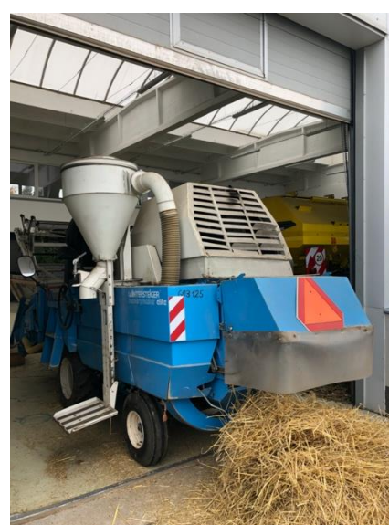
Obr. 5 a 6: Výmlat vzorků maloparcelkovou sklízecí mlátičkou Wintersteiger Classic (foto Chára)
