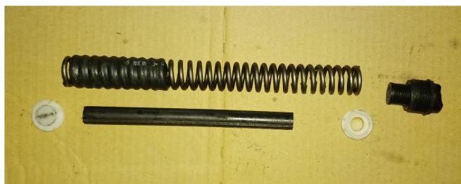
Obr. 4-8 Vnitřní části vidlice
