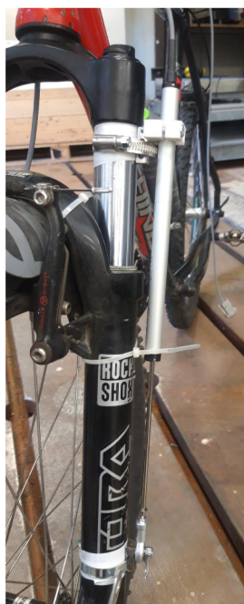
Obr. 6-2 Lineární potenciometr připevněný k vidlici
