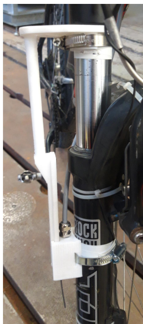
Obr. 6-1 Prototyp držáku připevněný k vidlici
