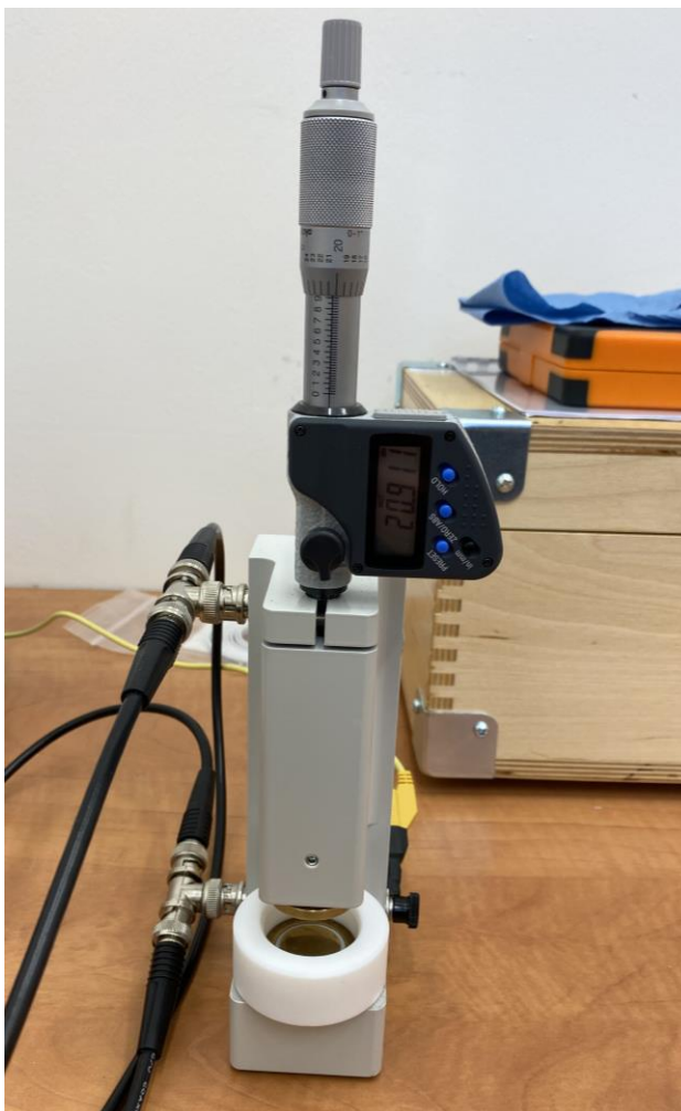
Obrázek 15 Držák na vzorky při měření (vlastní fotografie)
