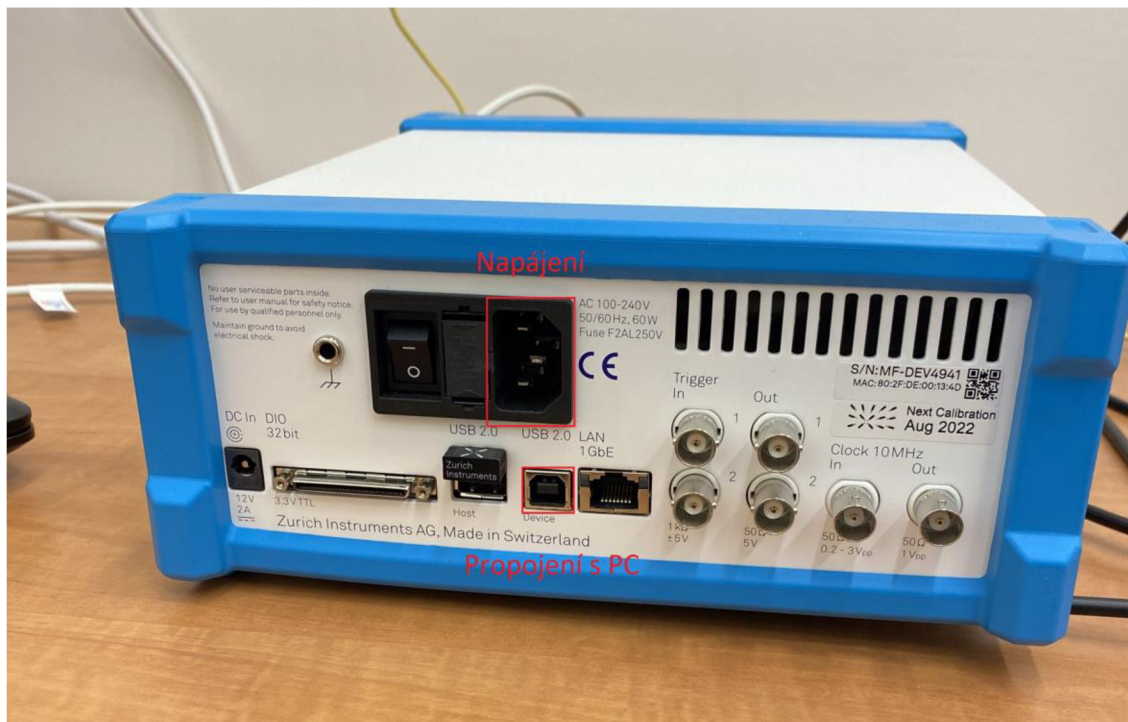
Obrázek 17 MFLI propojení s PC a napájení (vlastní fotografie)
