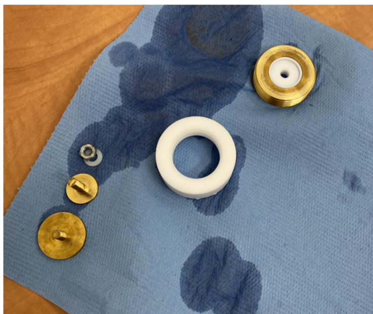
Obrázek 20 Jednotlivé části elektrod (vlastní fotografie)
