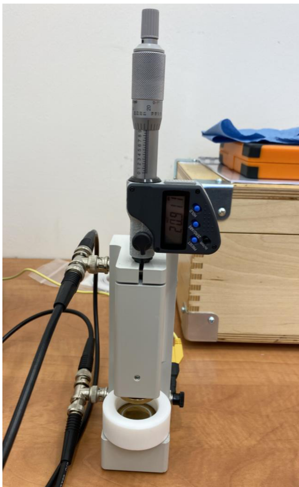
Obrázek 15 Držák na vzorky při měření (vlastní fotografie)
