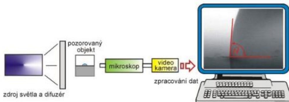
Obrázok 6: Schéma usporiadania aparatury na meranie kontaktného uhlu pomocou metódy prisadnutej kvapky. Prevzaté z [3]
