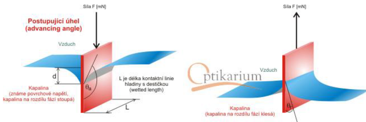
Obrázok 3: Vyvažovanie Wilhelmyho doštičky. Prevzaté z [7]
