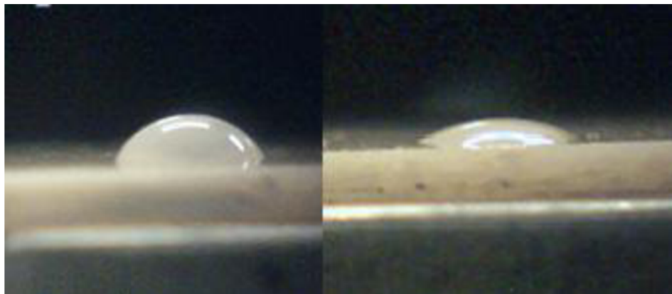
Obrázok 21: Vľavo: kvapka glycerolu na neopracovanej vzorke PHB PLA. Vpravo: kvapka glycerolu na opracovanej vzorke PHB – PLA
