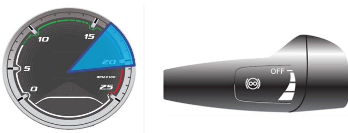
Obr. 1.6 Modrá zóna otáčkoměru pro použití motorové brzdy a ovladač motorové brzdy nalézající se vpravo pod volantem
