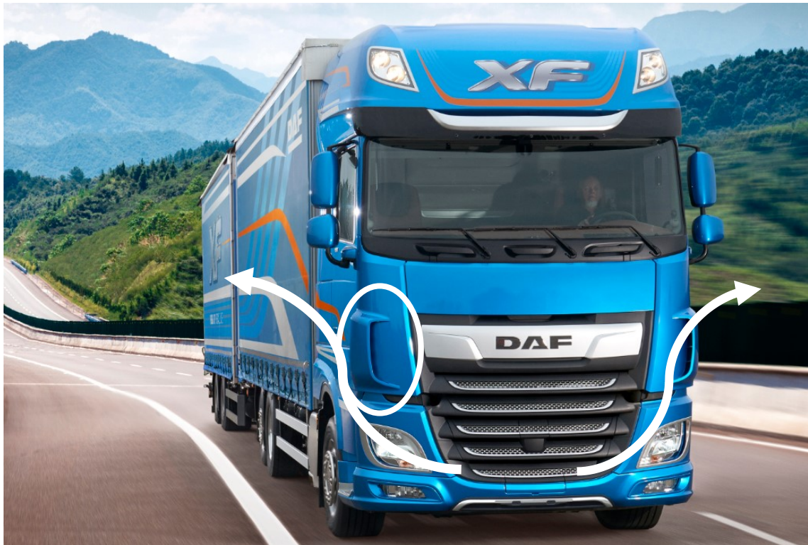
Obr. 1.3 Odtok vzduchu a pomocná křídélka na čelní straně kabiny
