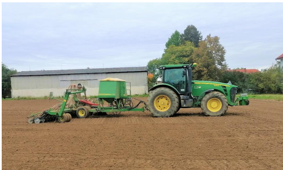
Obrázek 5.1: Secí stroj John Deere 740 A naváděný pomocí navigace
