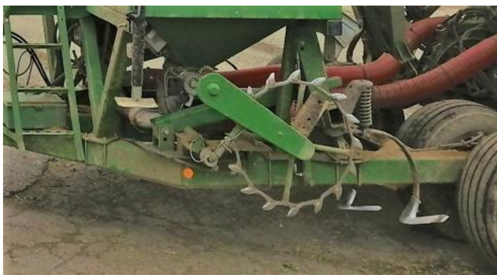
Obrázek 5.2: Ostruhové kolo pro ovládání výsevního ústrojí
