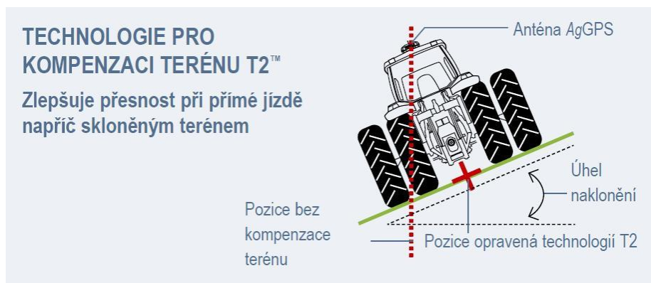
Obrázek 4.6: Princip svahové kompenzace terénu T2 (Agrisystem.cz, 2021)
