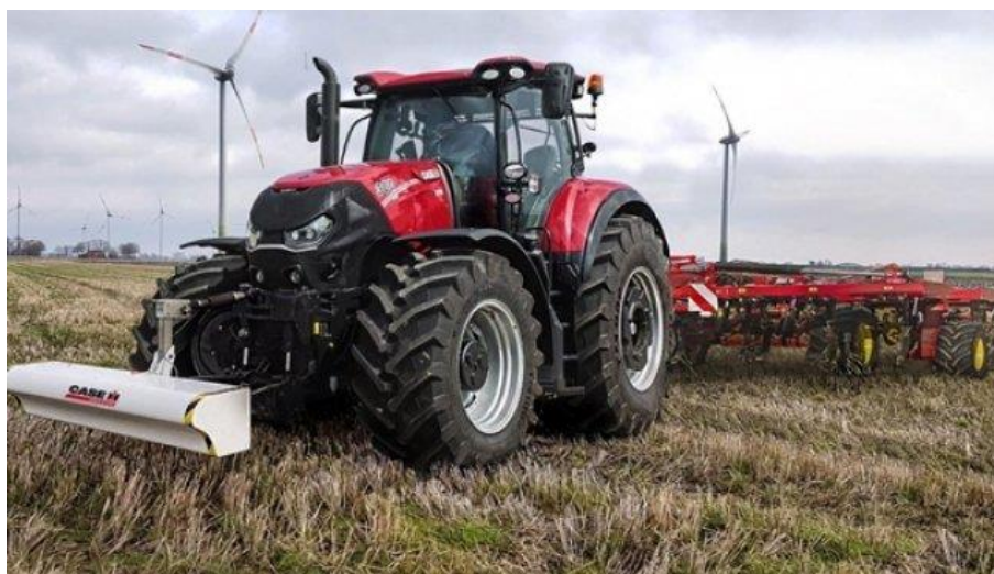
Obrázek 4.9: Půdní senzor od firmy Köckerling ve spolupraci s Case IH (Jedlička, 2018)
