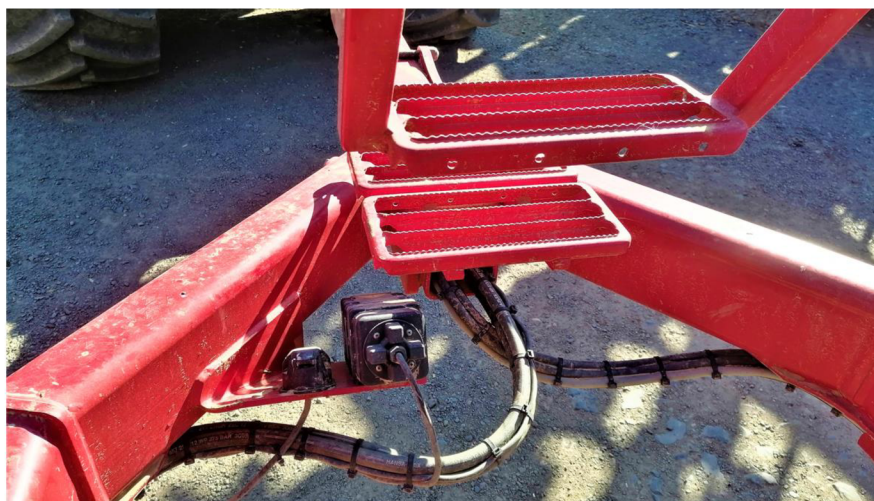
Obrázek 5.4: Laserový snímač pojezdové rychlosti pro ovládání výsevního ústrojí
