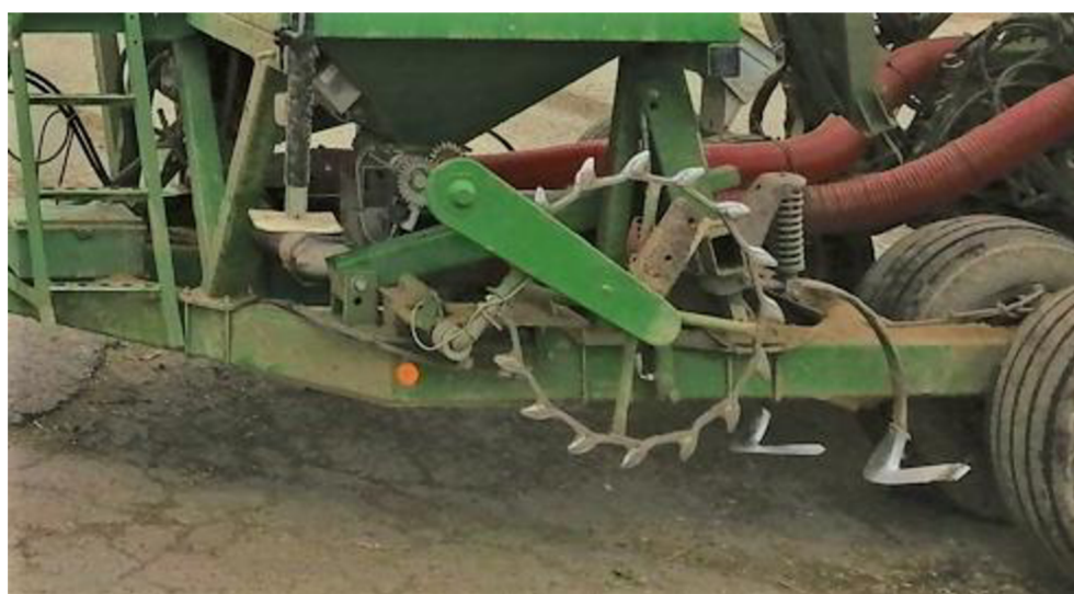
Obrázek 5.2: Ostruhové kolo pro ovládání výsevního ústrojí
