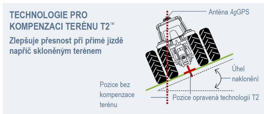
Obrázek 4.6: Princip svahové kompenzace terénu T2 (Agrisystem.cz, 2021)
