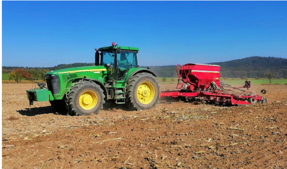
Obrázek 5.3: Secí stroj Horsch Pronto 6 DC naváděný znamenákem
