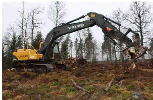
Obr. 8 Volvo – hydraulické nůžky na ostříhávání kořenů pařezů
