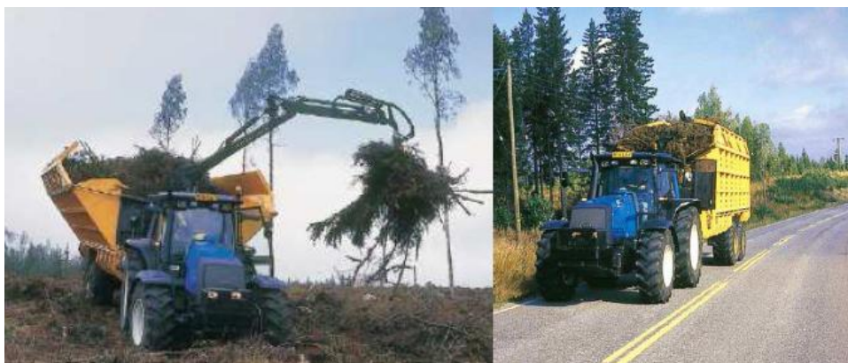
Obr. 12 Vyvážecí přívěs umožňující kompresi – nakládání (Havu-Hukka, Finsko)
