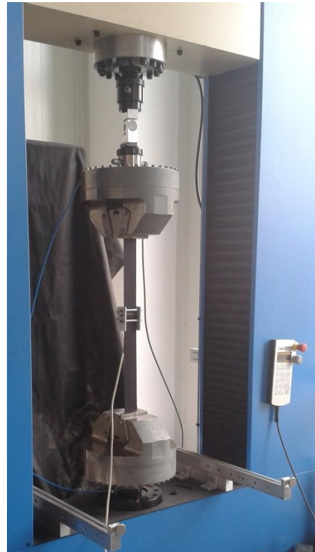
Obr. 10.1: Kalibrace měřidla v univerzálním zkušebním stroji
