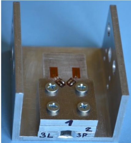
Obr B2: Pořadí podložek, včetně otvoru pro kabel (mezi 3L a 3P) a sražení hran kolem otvoru pro kabel
