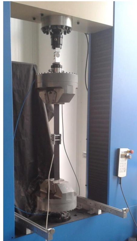
Obr. 10.1: Kalibrace měřidla v univerzálním zkušebním stroji
