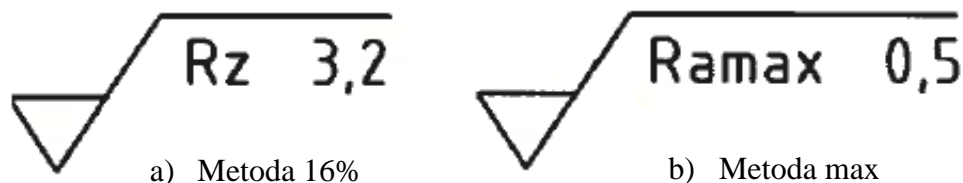
Obr. 12) Označování drsnosti povrchu na výkrese podle ISO 1302 [17]
