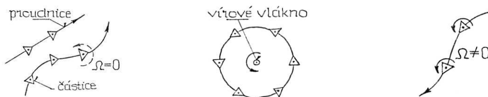
Obr. 30: Schéma potenciálního (nevířivého) a vířivého proudění: potenciální proudění po křivce (vlevo), potenciální vír (uprostřed), vířivé proudění (vpravo) [14].
