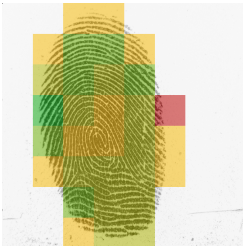
Obrázek 6.2: Grafický výstup v podobě barevné mapy. V pravé dolní čtvrtině je viditelná prasklina, kterou algoritmus na určení pozadí úspěšně odfiltroval.
