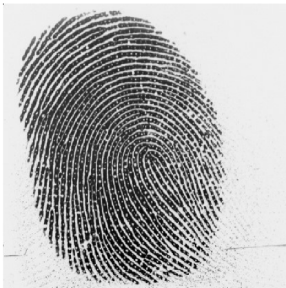
Obrázek 2.7: Ukázka otisku prstu získaného na snímači s prasklým sklíčkem.
