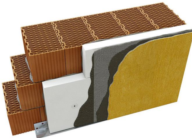
Obrázek 4: Kontaktní zateplovací systém obvodových stěn [19]
