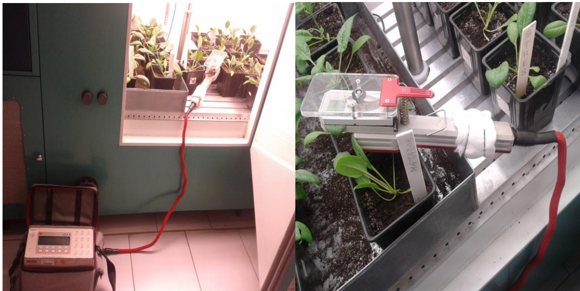
Obr. 16. - 17.: Měření výměny plynů přenosným analyzátozem
