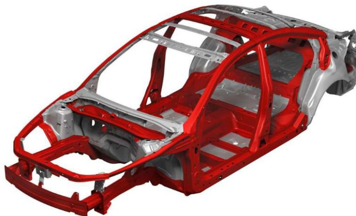
Obr. 12 Skořepinová konstrukce kostry automobilu [6]
