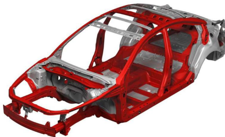
Obr. 12 Skořepinová konstrukce kostry automobilu [6]
