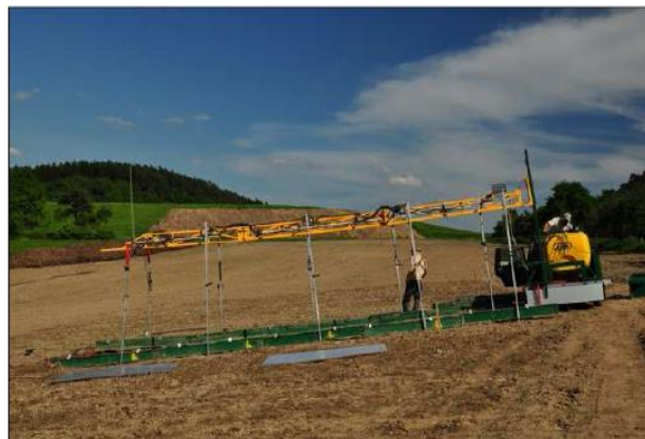
Obr. 7: Pohled na rozložený simulátor (Zdroj: VÚMOP)
