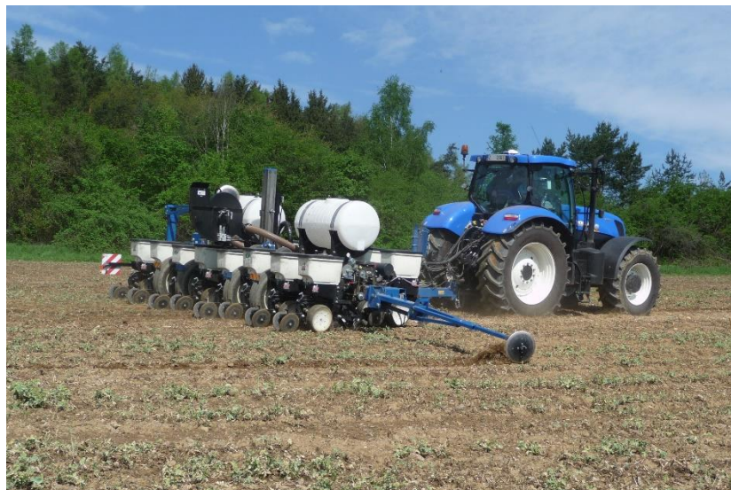
Obr. 11: Secí stroj KINZE 3500 8 R Interplant (Zdroj: A Šedek)
