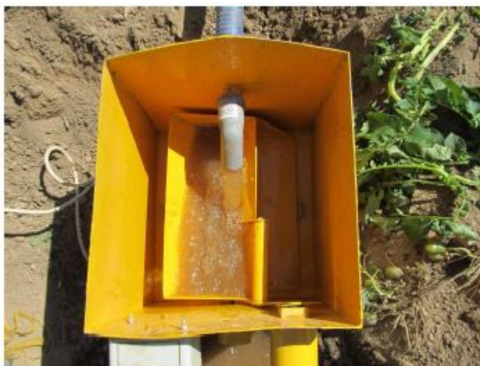
Obr. 8: Průtokoměr simulátoru s překlápěcím mechanismem (Zdroj: VÚMOP)
