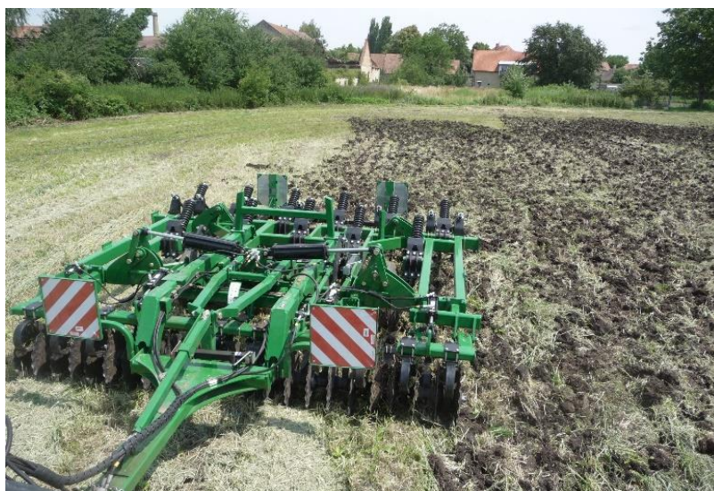
Obr. 4: Hlubkový kypříč Great Plains Turbo Chisel TCN 5311 pracuje až do hloubky 34 cm. Půdu v celém profilu nadzvedává, ale neobrací. Rozteč pracovních orgánů je 38 cm. (Zdroj: Šedek 2012)
