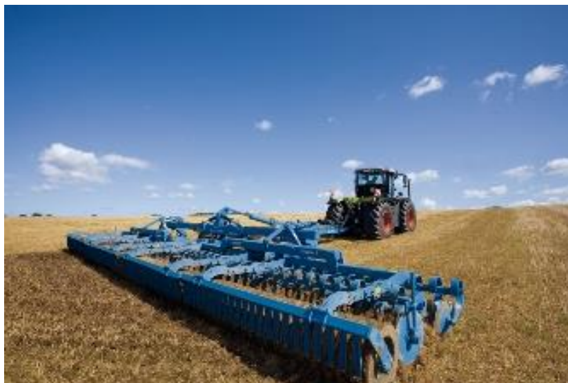
Obr. 12: Diskový podmítač Lemken – Rubin (Zdroj: www.lemken.cz )
