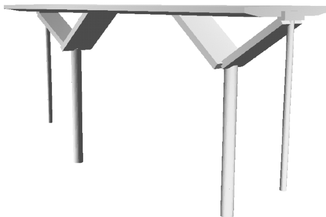
Obr. 3-2 Rendering prutového 1D modelu v programu Nexis 32 [1]
