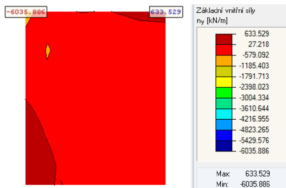
Obr. 6-27 Deskostěnový 2D model, detail, šikmá stojka
