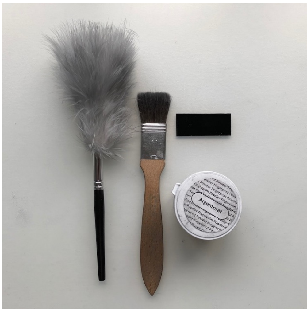
Obrázek 7: Použitá sada pro sejmutí otisku ze skla
