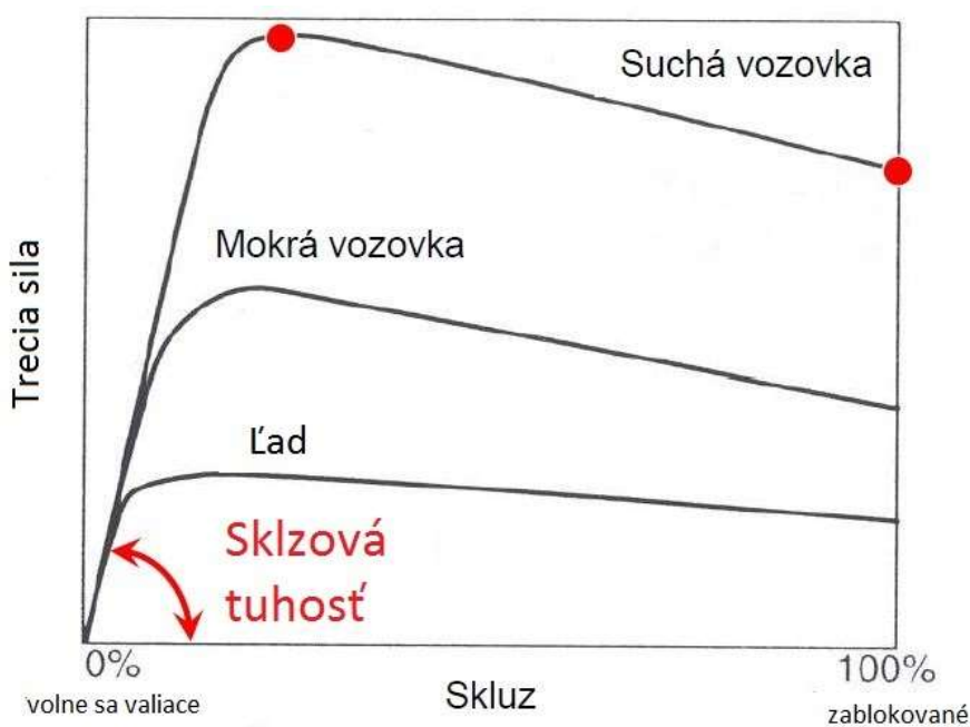
Obrázok 19 Závislosť hnacej sily na sklzu a sklzová tuhosť [9]
