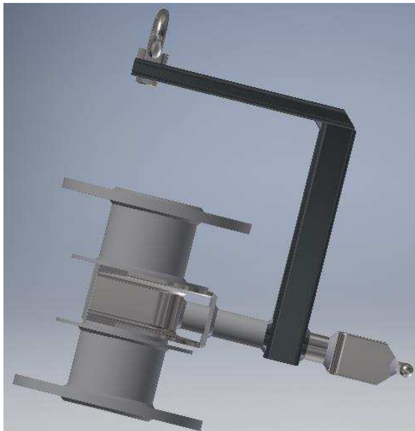
Obr. 24) Funkce ustavení součásti v přípravku při nadzvednutí
