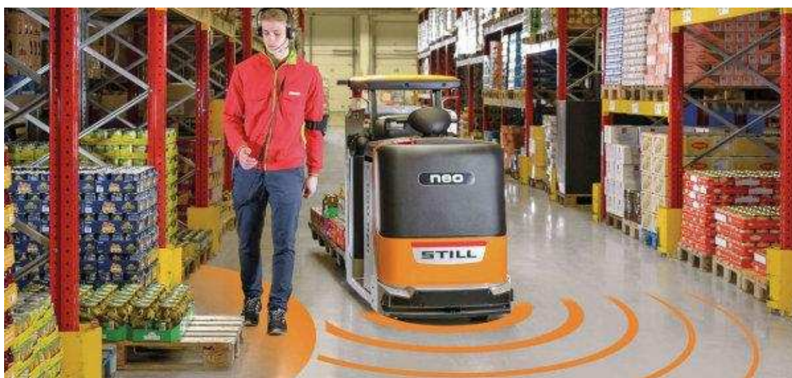
Obr. 4) Autonomní vychystávací vozík Still[5]
