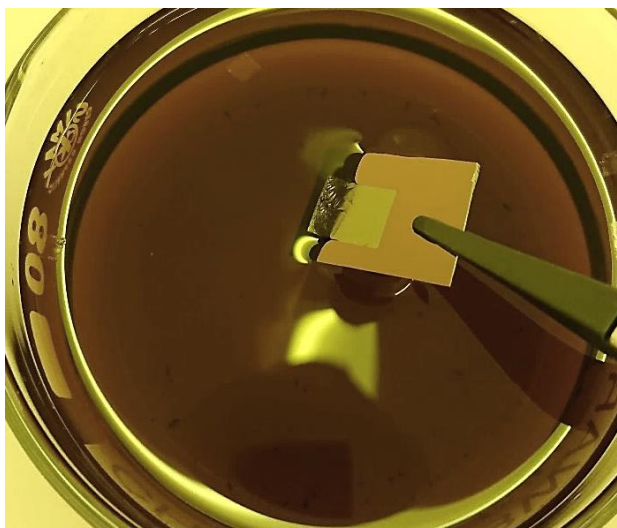
Obr. 18: Přenos grafenu zpevněný vrstvou PMMA z hladiny roztoku dusičnanu železitého pomocí křemíkové destičky.
