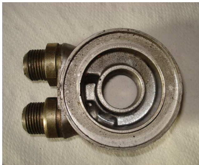
Obr. 19 Přípravek na odvod oleje do chladiče a zpět do oběhu
