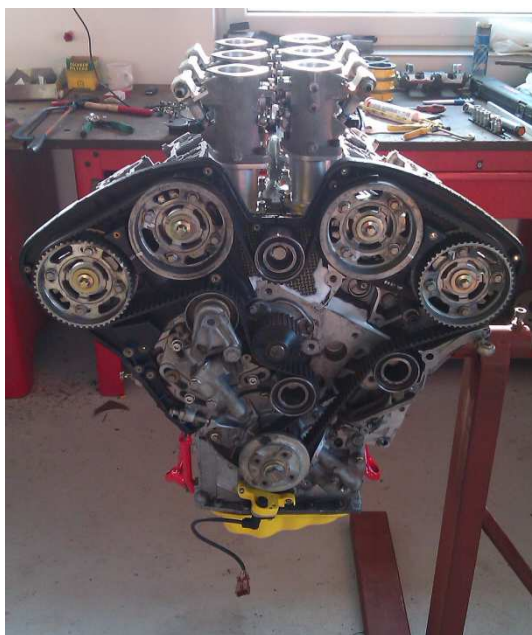
Obr. 21 Motor s odkrytým rozvodem a dvěma částmi sání
