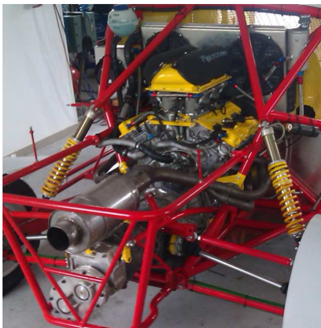
Obr. 20 Motor i s převodovkou namontován na rám automobilu
