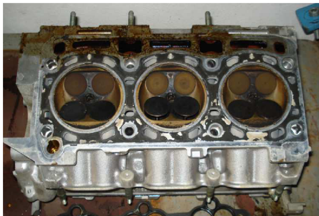
Obr. 5 Dosedací plocha hlavy válců i s ventily
