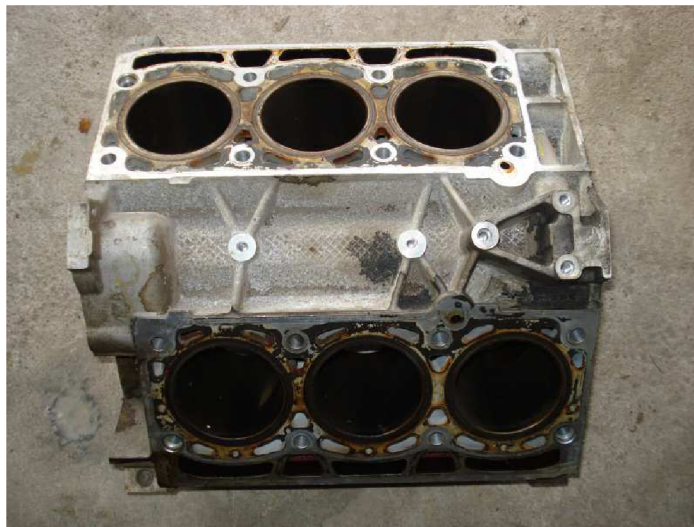
Obr. 4 Blok atmosférického šesti-válcového motoru
