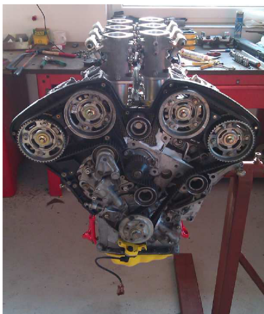
Obr. 21 Motor s odkrytým rozvodem a dvěma částmi sání
