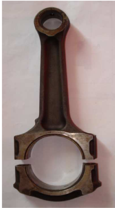
Obr. 10 Původní ojnice s ojnicími ložisky, bez spojovacích šroubů
