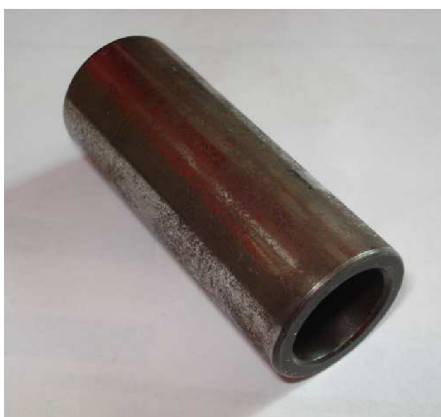
Obr. 14 Původní pístní čep
