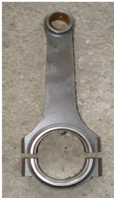
Obr. 12 Závodní ojnice s ojnicími ložisky, bez spojovacích šroubů
