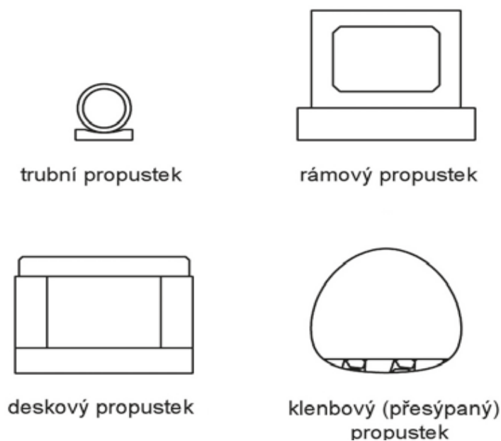
Obrázek 3-3 Typy konstrukce propustků. Zdroj: TD LDS
