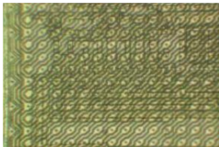
Obr. 6.1: Mřížka složená z napájecích a zemnicích vodičů.
