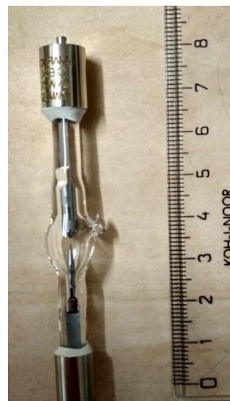
Obr. 4.2 Výbojka pro impulzní zdroj
